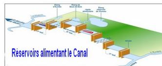
**L'étang du grand Vioreau** (d'une capacité maximum de 7 451 000 m<sup>3</sup> d'eau pour 9,10 m de cote) est le plus grand réservoir du département. D'une superficie de 180 ha, c'est un barrage qui fait de lui en toute saison le réservoir d'eau du canal.
